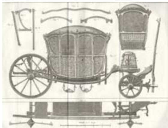
Plans d'une berline de voyage à 4 portières L'Encyclopédie ou Recueil des planches sur les sciences, les arts libéraux et les arts mécaniques , Paris, Brisson, 1771, 9 volumes, Tome IX, article "sellier-carrossier" planche VII.
